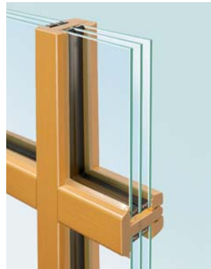
Glasteilende Sprosse Classic 9.0 3fach-Glas Sprossenbreite 60 mm (Optional 70, 80, 90, 100 mm)
